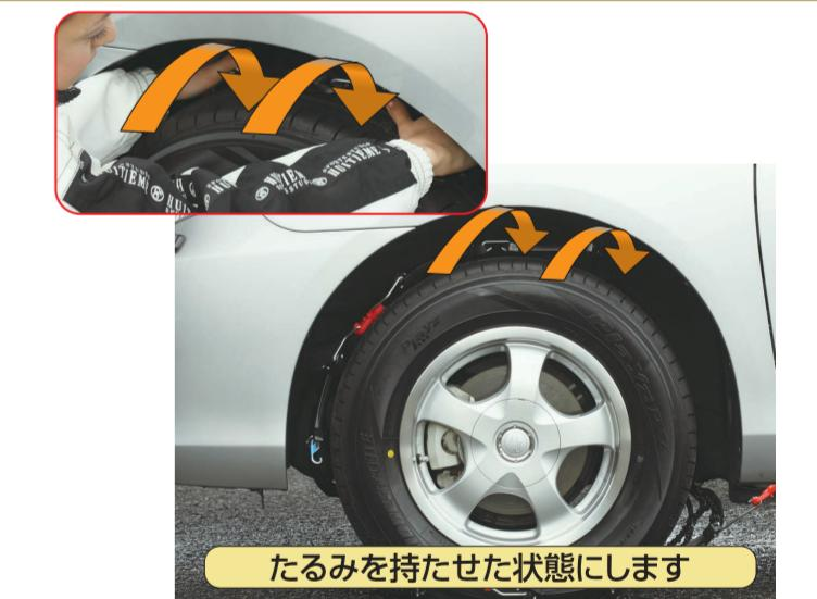
シールが貼られているフックと対角線上にあるロック部のフックを外し、タイヤ上側のバイアスロンをタイヤ裏側に充分に落とし込みます。
