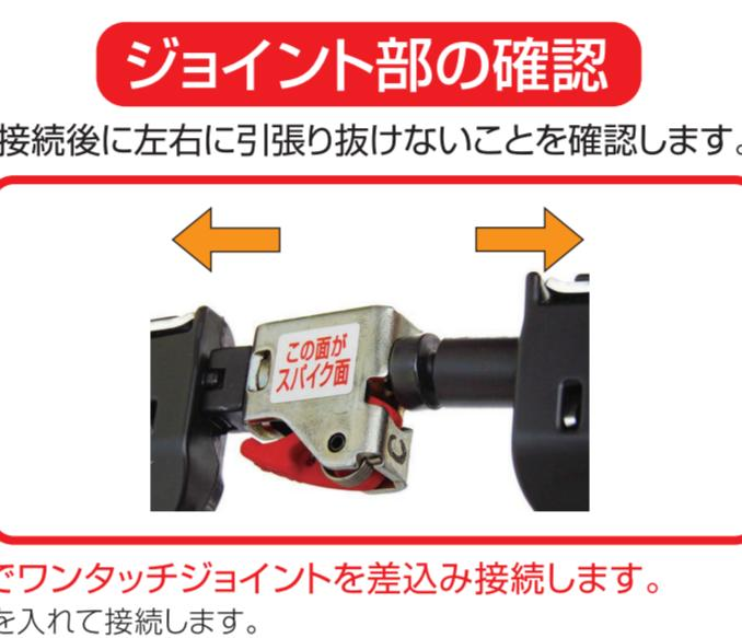
タイヤ上部でジョイントホールにカチッと音がするまでワンタッチジョイントを差込み接続します。
