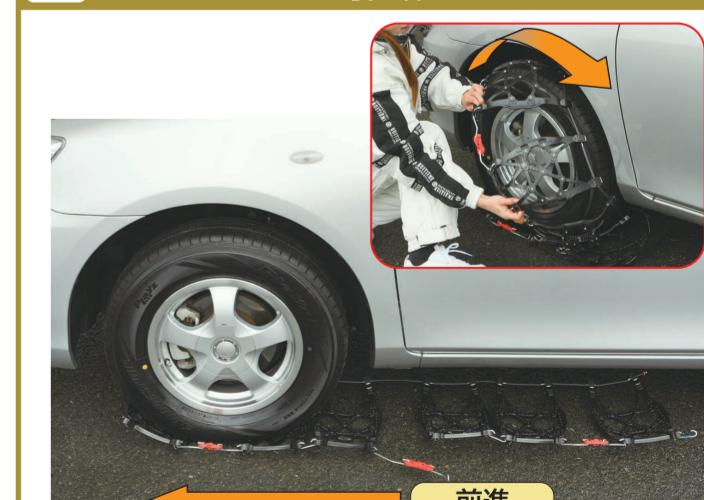
バイアスロンをタイヤに沿って引き伸ばして地面に敷き、車を移動してバイアスロンを取出します。
