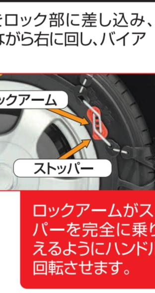
B→A→Cの順でハンドルをロック部に差しこみ、ロック部をタイヤに押しつけながら右に回し、バイアスロンを締め付けます。
