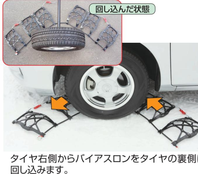
スパイク(金属部)が見えるようにワイヤー側を手前にして地面に置きます。
