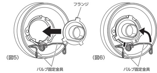
③ ヘッドランプユニットの切欠きに合わせて②で外したフランジを取り付けバルブ固定用金具でしっかりと固定します。(図5)(図6)
