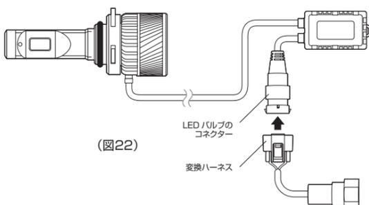
④ 7ページの①～⑥の手順に従いLEDバルブを取り付けます。
