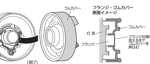
④ 灯具のゴムカバーを元に戻し、フランジの溝が見えるまで押し込みます。(図7)
