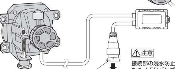
③ LEDバルブのコネクターと車両側コネクターを接続します。(図13)
