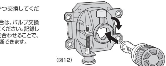
② 元のバルブを取り外した時と逆の手順でLEDバルブを取り付けます。(図12)
