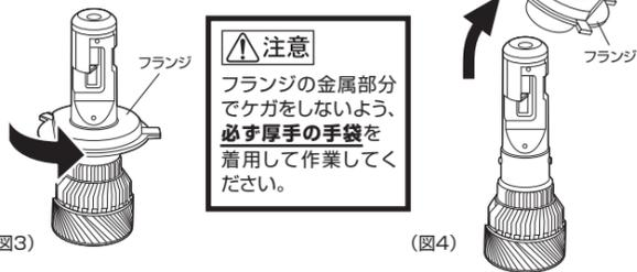
② LEDバルブのフランジを回して取り外します。(図3)(図4)
